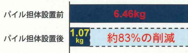
▲実証実験の結果（排水1m³あたりの平均余剰汚泥発生量）
